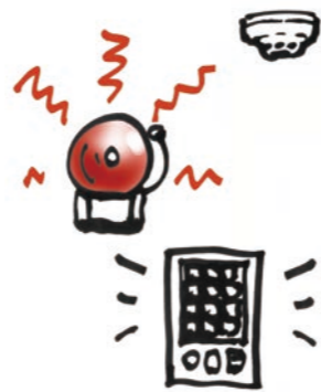
自動火災報知設備
