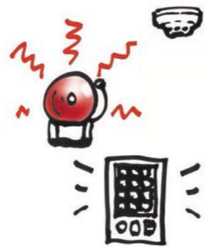
自動火災報知設備
